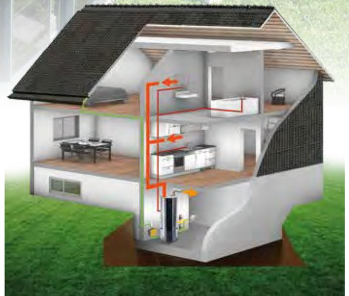
Die Zieltemperatur im Photovoltaik Modus kann erhöht werden, so dass durch den Solarstrom mehr Energie eingelagert werden kann. Die überschüssige Sonnenenergie wird somit optimal genutzt.
